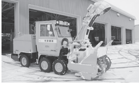
歩道の除雪などに活用される小型ロータリー除雪車
